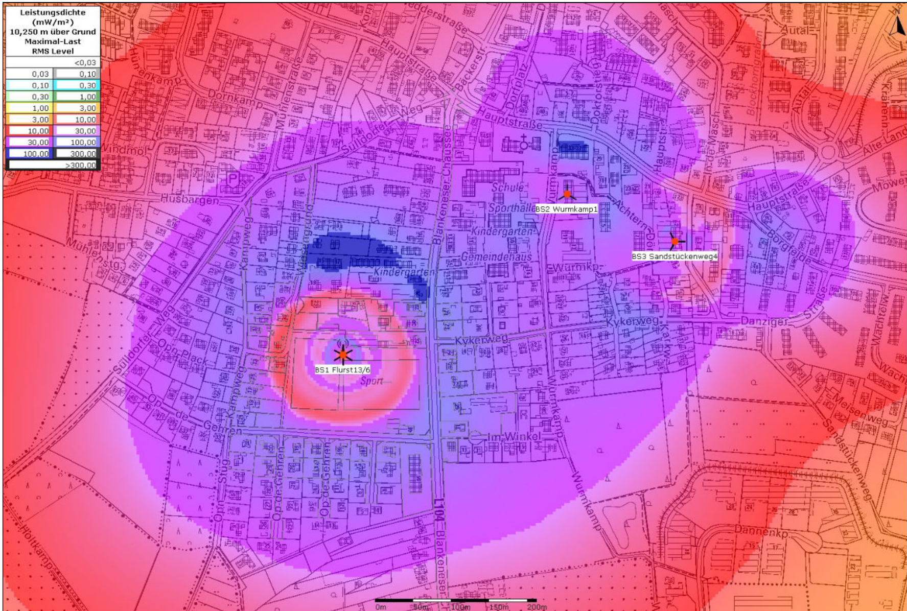
Karte 12: Typische Betriebsituation, alle Basisstationen, Immissionen in 10,25 m Höhe über Boden, Übersichtsdarstellung
