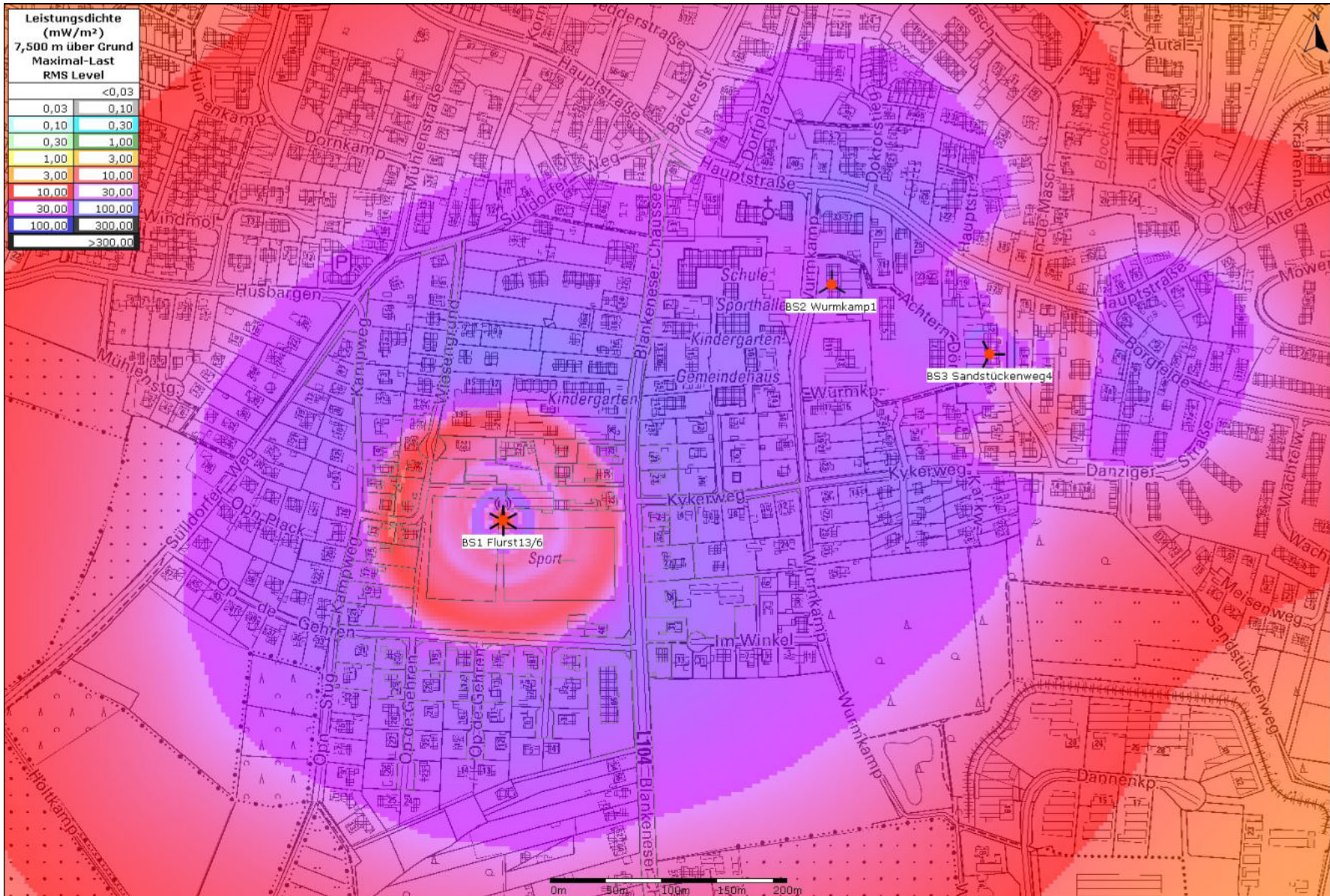
Karte 11: Typische Betriebsituation, alle Basisstationen, Immissionen in 7,50 m Höhe über Boden, Übersichtsdarstellung
