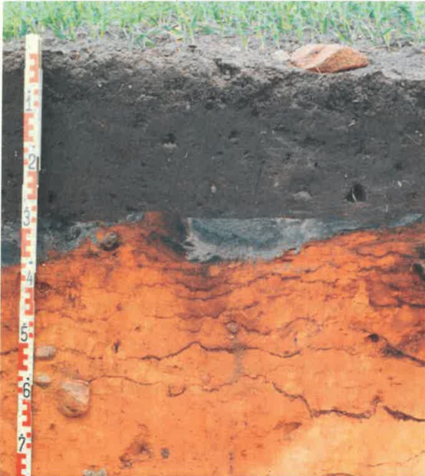
Abbildung 14 – Aufbau / Systemquerschnitt eines Podsol – Braunerde-Bodenprofils
