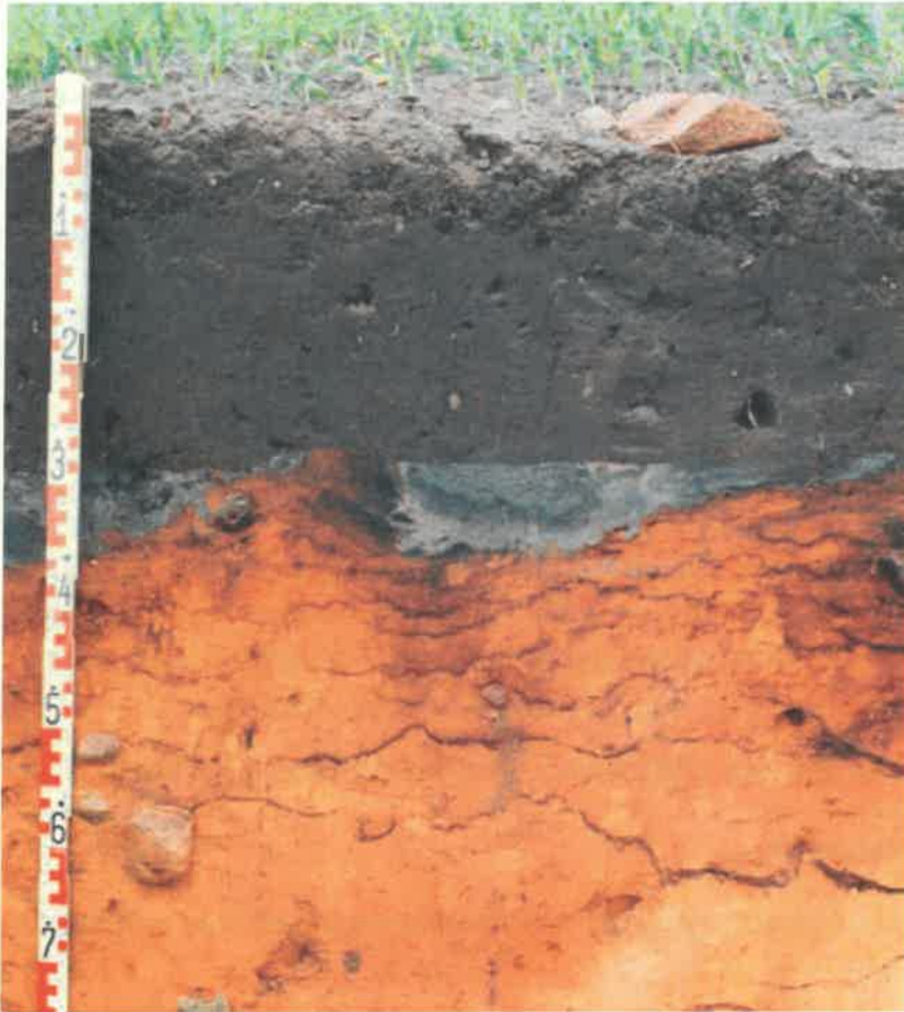
Abbildung 14 – Aufbau / Systemquerschnitt eines Podsol – Braunerde-Bodenprofils
